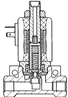
Zawór elektromagnetyczny bezpośredniego działania dla neutralnych gazów i cieczy. Przeznaczony dla wysokich temperatur, dla gorącej wody, gorącego powietrza, pary i oleju grzewczego.
